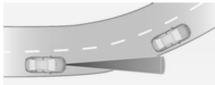
Система адаптивного круиз-контроля рассчитывает предполагаемую траекторию движения автомобиля, используя данные о центробежной силе. При расчете траектории учитывается кривизна участка, по которому автомобиль движется
