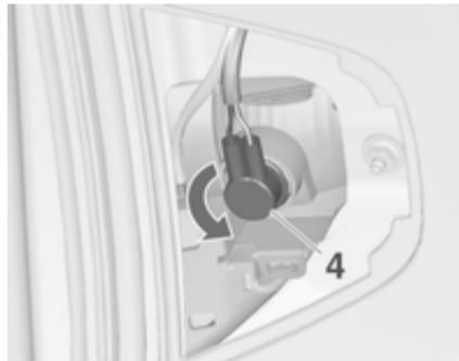
2. Поверните патрон лампы против часовой стрелки и извлечь его из рефлектора.
