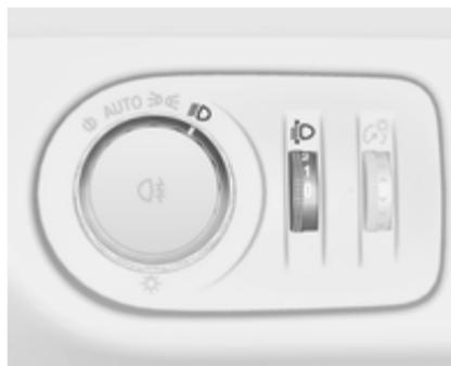
Чтобы подстроить наклон света фар в соответствии с загрузкой автомобиля во избежание ослепления встречных водителей: поверните колесико с накаткой  $\diamond$  в требуемое положение.
