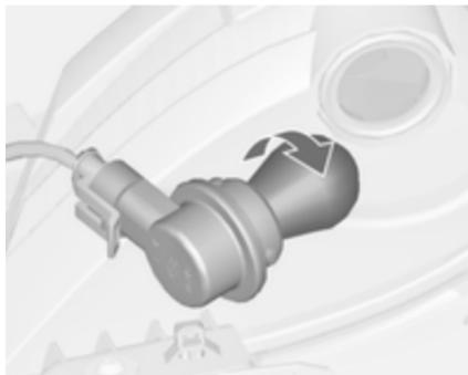
2. Извлеките лампу из патрона, вращая ее против часовой стрелки.
