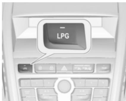
Нажатие на кнопку **LPG** переключает режимы работы с бензина на сжиженный газ и наоборот. Состояние светодиода соответствует текущему рабочему режиму.
