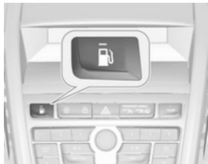
Нажатие на кнопку переключает режимы работы с бензина на природный газ и наоборот. Состояние светодиода соответствует текущему рабочему режиму.
