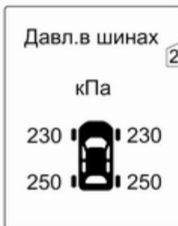
Поверните кольцо для выбора системы контроля давления в шинах. О состоянии системы и падении давления водитель извещается посредством предупреждающих сообщений, при этом на дисплее информационного центра водителя начинает мигать знак соответствующей шины.
