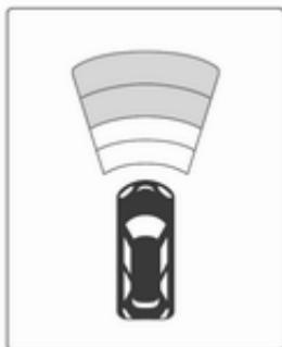
В версии с дисплеем Uplevel расстояние до находящегося впереди препятствия отображается при помощи сегментного индикатора.
