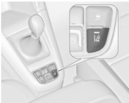
Система предупреждения о выходе за пределы полосы движения включается нажатием на кнопку
