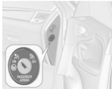
Систему воздушных подушек безопасности переднего пассажира можно отключить ключом, вставив его в выключатель с замком, который расположен с правой стороны приборной панели.
