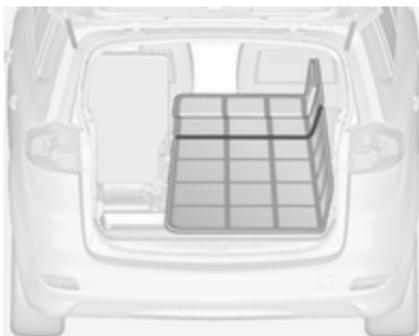
Пример укладывания коврика для защиты боковой стенки багажного отделения.
