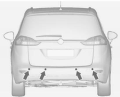
Система облегчения парковки передним и задним ходом измеряет расстояние между автомобилем и препятствиями, находящимися спереди или сзади автомобиля. Система подает звуковой сигнал и выводит на дисплей предупредительные сообщения.
