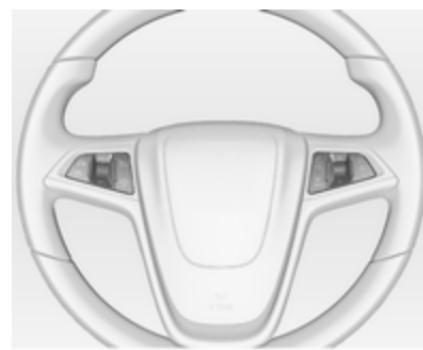
С помощью органов управления на рулевом колесе можно управлять информационно-развлекательной системой, некоторыми системами помощи водителю и подключенным сотовым телефоном.
