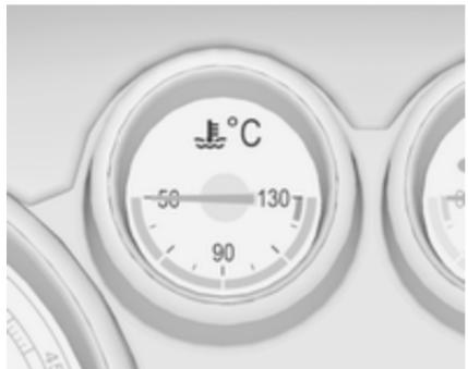
Отображает температуру охлаждающей жидкости двигателя.
