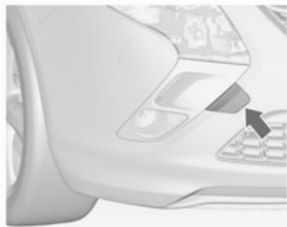
Вставьте отвертку в прорезь у более короткого края заглушки. Извлеките заглушку, аккуратно отогнув отвертку в сторону. Во избежание повреждения рекомендуется поместить между отверткой и рамой тряпку.
