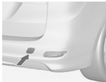
Вставьте отвертку в прорезь у нижнего края заглушки. Освободить колпачок, аккуратно сдвинув отвертку вниз. Во избежание повреждения рекомендуется поместить между отверткой и рамой тряпку.
