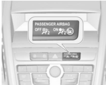
Если после включения зажигания контрольный индикатор ВКЛ $\text{X}_2$  загорается примерно на 60 секунд, это означает, что в случае столкновения подушка безопасности переднего пассажира сработает.
