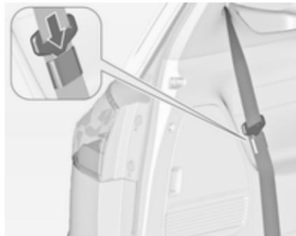
Прежде чем устанавливать крышку багажного отделения, вставьте язычки боковых ремней безопасности в специальные карманы, расположенные на ремнях.
