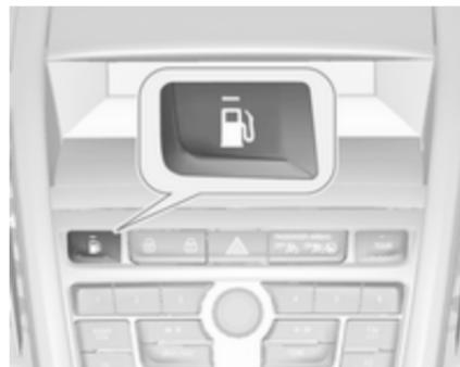
Нажатие на кнопку переключает режимы работы: с бензина на природный газ и наоборот. Режим работы не переключается при высоких нагрузках (например, во время интенсивного разгона или при полностью открытой дроссельной заслонке). Состояние светодиода соответствует текущему рабочему режиму.
