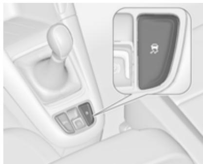
Систему контроля тягового усилия ТС можно выключить, если требуется пробуксовка ведущих колес автомобиля, для этого кратковременно нажмите кнопку
