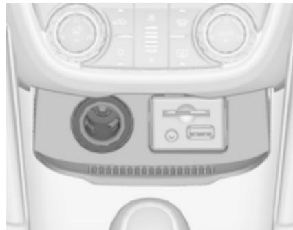
Розетка электропитания напряжением 12 вольт располагается в передней консоли. Опустить крышку вниз.
