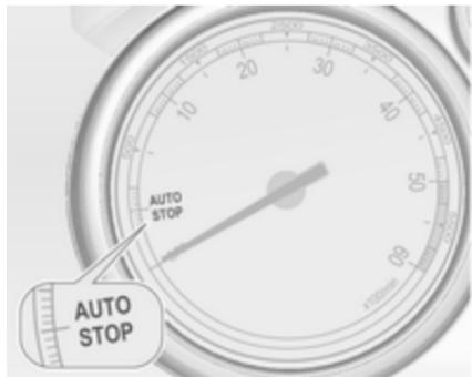
Если автомобиль движется с низкой скоростью или стоит на месте и при этом выполняются определенные условия, для включения функции Autostop необходимо выполнить следующие действия:
