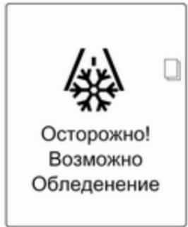
Если наружная температура опускается до 3 °C, на автомобиле с дисплеем верхнего уровня или комбинированным дисплеем верхнего уровня информационного центра водителя выводится предупредительное сообщение.
