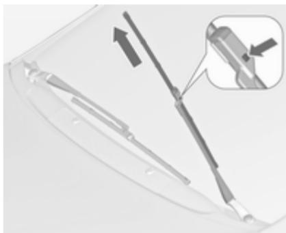
Поднимите рычаг стеклоочистителя, отведя ее от стекла, нажмите кнопку, чтобы освободить щетку стеклоочистителя, и выньте ее.
