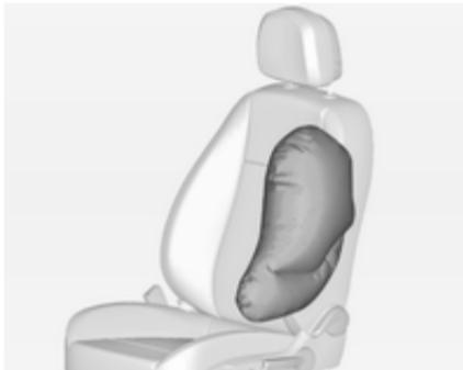
Надутые воздушные подушки безопасности амортизируют удар, тем самым они снижают опасность травмирования верхней части туловища и таза в случае серьезного бокового удара.
