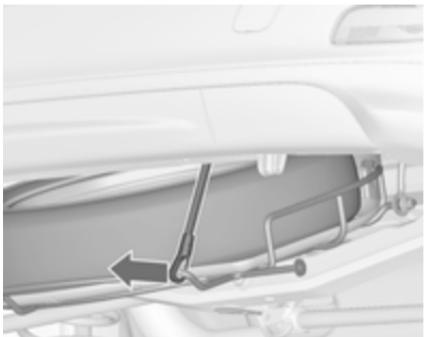
7. Снимите предохранительный трос.
