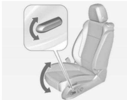
Сдвиньте передний край клавиши переднего выключателя вверх/вниз.
