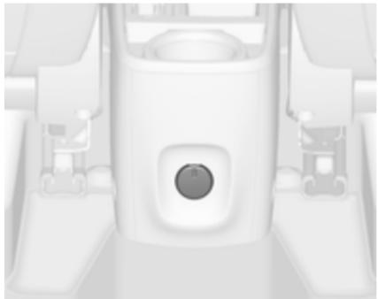
Дополнительные розетки для обеспечения питания напряжением 12 В расположены на задней консоли
