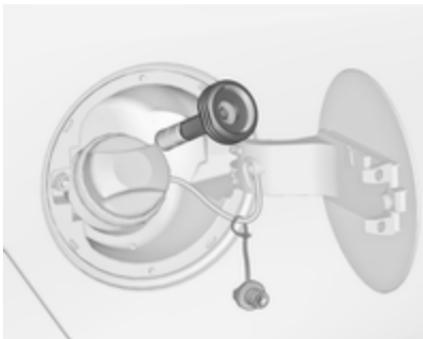
**Переходник ACME:** Накрутите гайку заправочного пистолета на переходник. Отожмите вниз рычаг блокировки пистолета.
