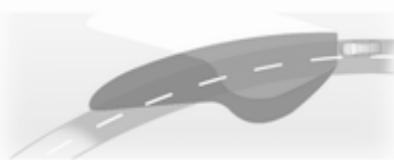
В зависимости от положения рулевого колеса и скорости движения происходит поворот светового луча, чем достигается улучшенная освещенность полотна дороги во время прохождения поворота.
