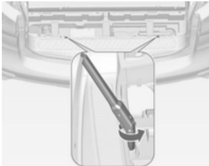
3. Установите баллонный ключ на один из болтов с шестигранной головкой и поворачивайте его против часовой стрелки, пока не почувствуете заметное сопротивление.
