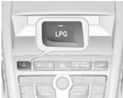
При нажатии клавиши LPG происходит переключение с бензина на СНГ, как только будут выполнены необходимые для этого условия (температура охлаждающей жидкости, температура газа и минимальная скорость вращения коленчатого вала двигателя). Эти условия обычно выполняются примерно через 60 секунд (в зависимости от температуры окружающей среды) и после первого выжимания педали акселератора. Состояние светодиода соответствует текущему рабочему режиму.
