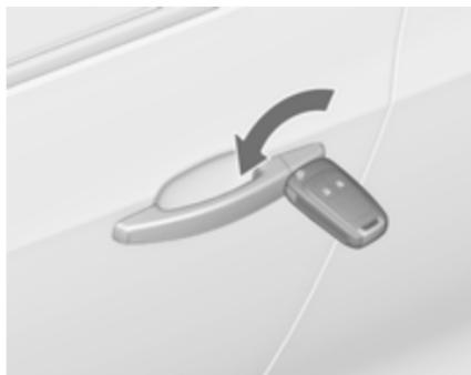
Разблокируйте дверь водителя вручную, повернув ключ в замке. Чтобы отпереть замки всех дверей, багажника и откидной крышки заправочной горловины топливного бака, следует включить зажигание и нажать кнопку центрального замка .
