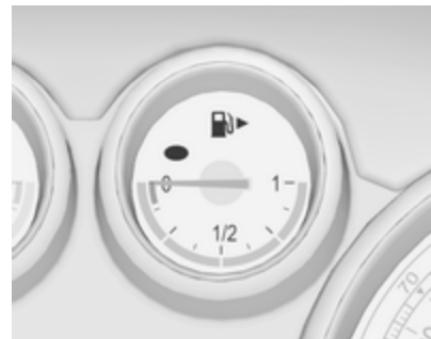
В зависимости от режима работы показывает уровень топлива или давление газа в баке.
