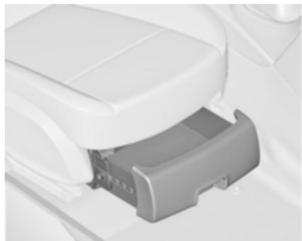
Утопить кнопку в гнезде и вытащить ящик наружу. Максимальная нагрузка: 3 кг. Чтобы закрыть ящик, нажать на него до фиксации.
