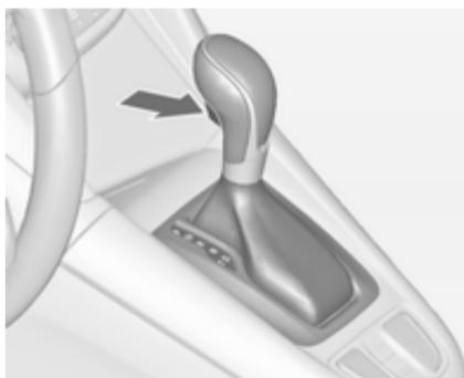
**P** = положение для парковки, колеса заблокированы, допускается устанавливать только на стоящем автомобиле с включенным стояночным тормозом
