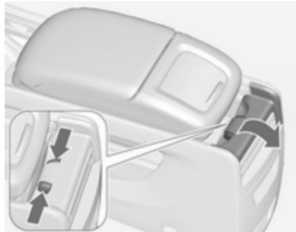
Сожмите вместе кнопки фиксатора, расположенного в задней части подлокотника и откиньте его вниз.
