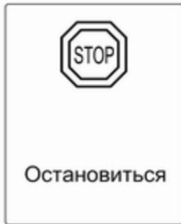
Система считает, что водитель выбрал предложенное ей место, если автомобиль остановился не более чем в 10 м от того места, где система выдала сообщение об остановке. Система вычисляет оптимальный маршрут для постановки автомобиля на парковку. Затем
