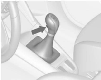
Чтобы включить задний ход, при неподвижном автомобиле выжать педаль сцепления, через 3 секунды нажать кнопку освобождения на рычаге переключения и включить передачу.
