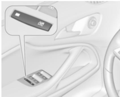
Для включения блокировки стекол задних дверей можно воспользоваться выключателем , при этом загорится светодиод индикатора. При повторном нажатии выключателя блокировка отключится.
