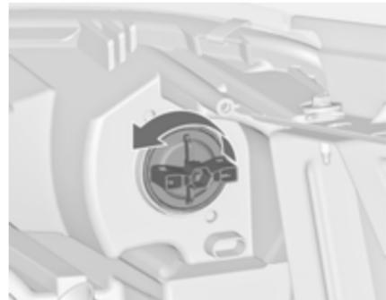
1. Поверните патрон (3) против часовой стрелки, чтобы отсоединить его. Извлеките патрон лампы из отражателя.
