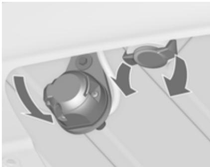
Отцепите и сложите гнездо. Снимите заглушку с отверстия для тягово-сцепного устройства и спрячьте ее.
