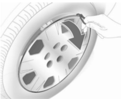
1. Подцепите колпачки колесных гаек отверткой и снимите их. Снимите колесный колпак с по-
