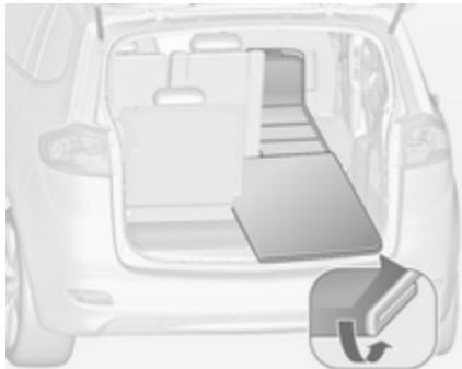
Пример укладывания коврика при одном сложенном сиденье второго ряда и одном сложенном сиденье третьего ряда.
