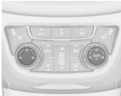
Если установлена минимальная температура (**Lo**) и включен режим охлаждения
