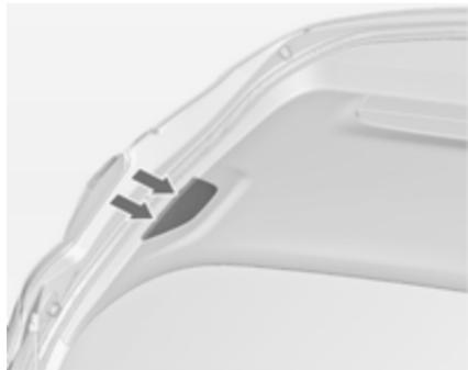
1. Откройте заднюю дверь багажного отделения и снимите заглушку.
