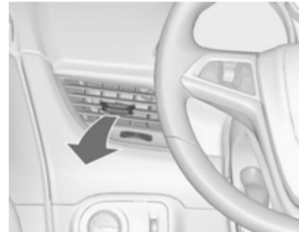
Чтобы закрыть отверстие, поверните регулировочный маховик в положение 0.
