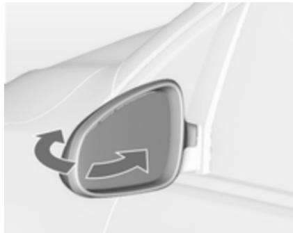
Для обеспечения безопасности пешеходов внешние зеркала складываются от удара определенной
