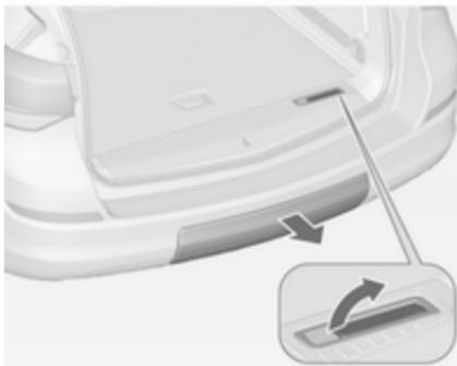
Потянуть рычаг освобождения вверх. Система разблокируется и будет быстро выдвинута из бампера.
