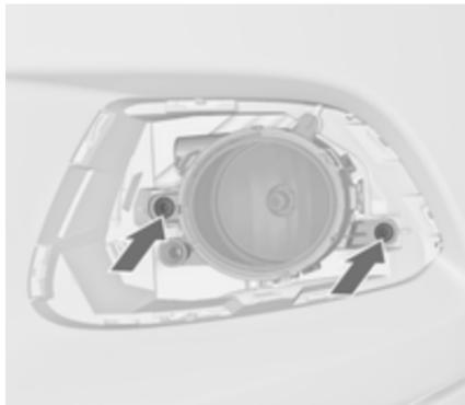
2. Отвернув оба винта, вынуть фонарь в сборе из бампера.
