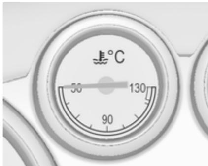
Отображает температуру охлаждающей жидкости двигателя.
