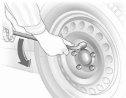
Установить колесный ключ так, чтобы он был надежно надет на гайку, слегка отвернуть каждую колесную гайку на пол-оборота.
