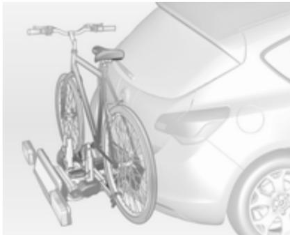
Задняя система перевозки грузов (система Flex-Fix) позволяет прикреплять велосипеды к выдвижной каретке, которая встроена в пол автомобиля. Транспортировка других объектов запрещена.
