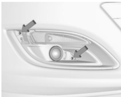
2. Отвернув оба винта, вынуть указатель поворота в сборе из бампера.
