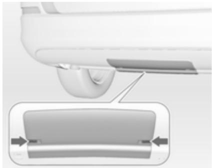
Все модификации, кроме модели с 3-дверным кузовом хэтчбек: Надавите на крепления вовнутрь и разложите заглушку, захватив ее за передний край. Снять крышку.
