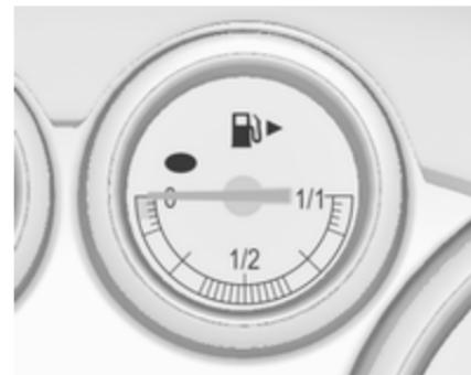
В зависимости от режима работы показывает уровень топлива в баке или газа в баллоне.
