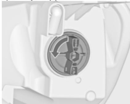
1. Поверните патрон (2) против часовой стрелки, чтобы отсоединить его. Извлеките патрон лампы из отражателя.
