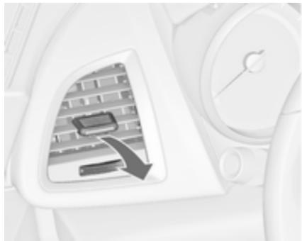
Наклоняя и поворачивая решетку, установите требуемое направление потока воздуха.
