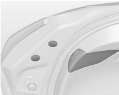
1. Открыв заднюю откидную дверь, снять сбоку крышку и обе заглушки.
