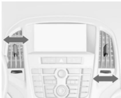
Чтобы открыть вентиляционное отверстие, следует повернуть колесико регулятора в сторону символа
