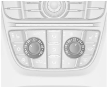
Если установлена минимальная температура (**Lo**) и включен режим охлаждения
