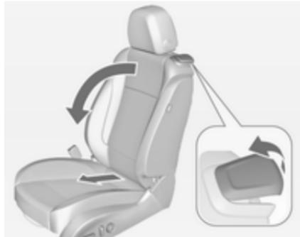
Поднимите рычаг фиксатора и сложите спинку вперед. Сиденье автоматически сдвигается вперед до упора.
