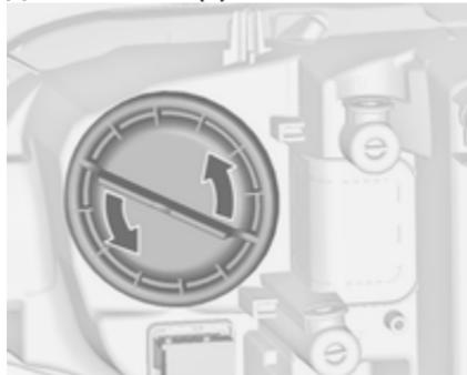
1. Поверните колпачок (2) против часовой стрелки и извлеките его.
