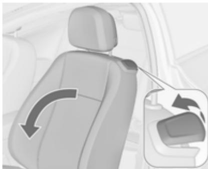
Поднимите рычаг фиксатора и сложите спинку вперед. Сдвиньте сиденье вперед.
