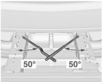
Задняя система перевозки грузов фиксируется, если повернуть захватные рычаги приблизительно на 50°. Если этого не сделать, безопасность эксплуатации не сможет быть обеспечена.
