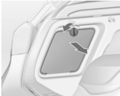
1. Снять крышку сбоку, предварительно её отпустив.
