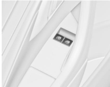
Потяните или нажмите клавишу выключателя стеклоподъемника, чтобы поднять или опустить стекло.
