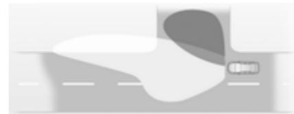
На крутых поворотах или при разворотах в зависимости от угла поворота руля или включенного указателя поворотов включается дополнительный левый или правый рефлектор, который освещает дорогу под прямым углом к направлению движения автомобиля.
