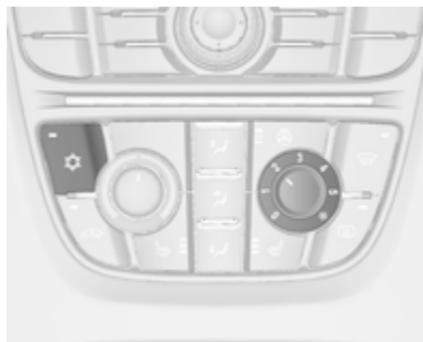
Нажмите клавишу , чтобы включить режим охлаждения. Включение подтверждается подсветкой клавиши. Охлаждение работает только при включенном двигателе и вентиляторе климат-контроля.
