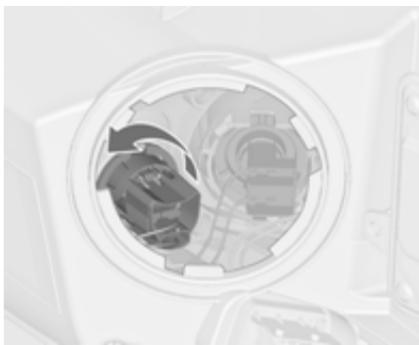
2. Поверните разъем лампы против часовой стрелки, чтобы его высвободить и вынуть из рефлектора.
