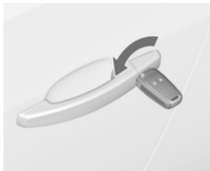
Отоприте дверь водителя вручную поворотом ключа в замке. Включив зажигание, нажмите кнопку центрального замка , чтобы отпереть замки остальных дверей, багажного отделения и крышки заливной горловины топливного бака. При включении зажигания противоугонная система отключается.
