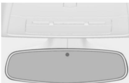
В темное время суток автоматически снижается ослепление водителя фарами едущих сзади автомобилей.
