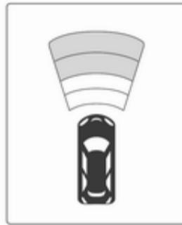
На экране дисплея верхнего уровня расстояние до препятствия спереди отображается в виде сменяющих друг друга сегментов на шкале.
