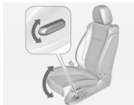
Сдвиньте передний край клавиши переднего выключателя вверх/вниз.
