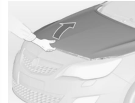
Сдвиньте предохранительную защелку вбок к левой стороне автомобиля и откройте капот.
