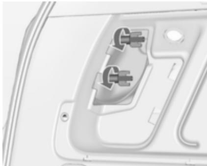
3. Открутите рукой две пластмассовые гайки крепления с внутренней стороны.
