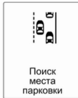
Когда автомобиль с включенной системой проезжает мимо ряда припаркованных автомобилей, система упреждающей помощи при парковке начинает искать свободное место для парковки. При обнаружении подходящего места
