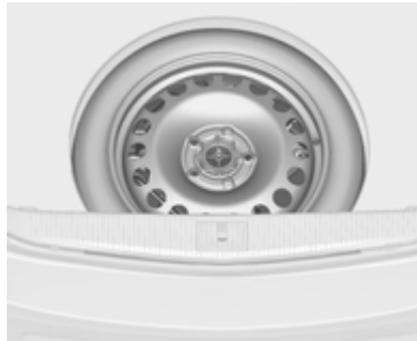
Запасное колесо хранится в багажном отделении под ковриком пола. Его крепление осуществляется барабанкой гайкой.
