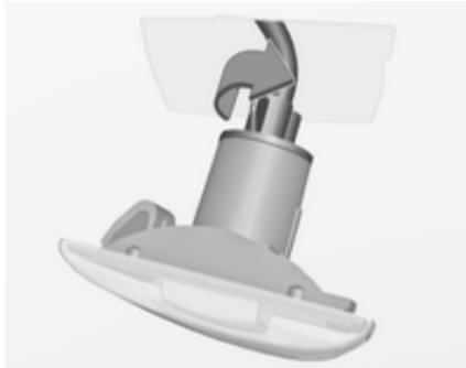
2. Поверните патрон против часовой стрелки и выньте его из корпуса фонаря.
