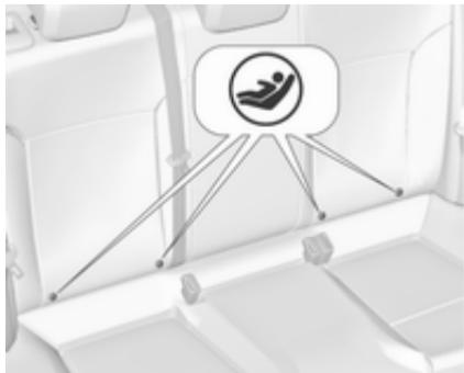
Закрепите разрешенные для применения в этом автомобиле ISOFIX системы безопасности детей ISOFIX в крепежных скобах. Позиции крепления ISOFIX детских кресел безопасности, применяемые для конкретного автомобиля, отмечены в таблице сокращением IL.
