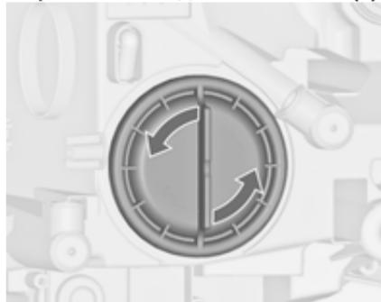
1. Поверните колпачок (1) против часовой стрелки и извлеките его.
