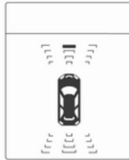
На экране комбинированного дисплея верхнего уровня расстояние до препятствия спереди или сзади отображается в виде сменяющих друг друга линий вокруг автомобиля.
