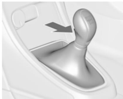
Задний ход: при неподвижном автомобиле выжать педаль сцепления, через 3 секунды нажать кнопку освобождения на рычаге переключения и включить передачу.
