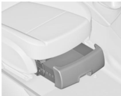
Утопить кнопку в гнезде и вытащить ящик наружу. Максимальная нагрузка: 3 кг. Чтобы закрыть ящик, нажать на него до фиксации.
