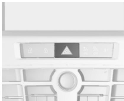
Включается с помощью кнопки  $\Delta$ . При аварии и срабатывании надувных подушек безопасности автоматически включается аварийная световая сигнализация.
