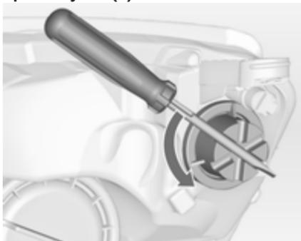
1. Поверните колпачок (3) против часовой стрелки и извлеките его. Для поворота колпачка использовать отвертку.
