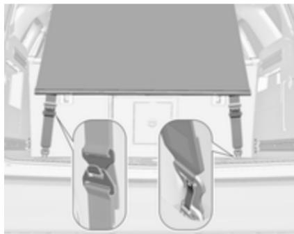
Прикрепите нижние крюки, развернув их назад, к петлям в правой и левой части пола багажного отделения. Отрегулируйте длину ремня багажной сетки, закрепив верхний
