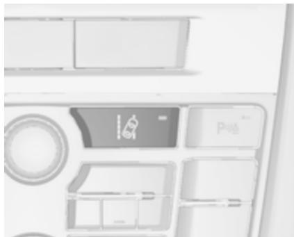
Система предупреждения о выходе за пределы полосы движения включается нажатием на кнопку . При этом включается светодиод подсветки кнопки. Включение
