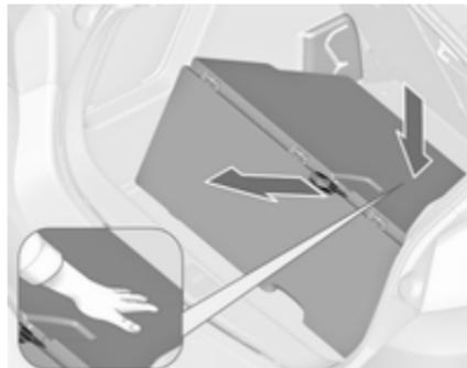
Чтобы опустить крышку, следует потянуть ремень назад и одновременно опустить середину передней части крышки.
