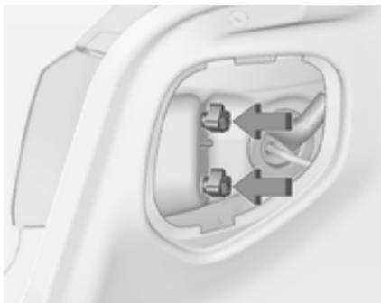
2. Открутите рукой две пластмассовые гайки крепления с внутренней стороны.
