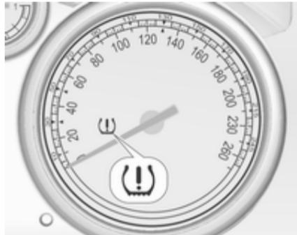
В случае выявления падения давления воздуха вшине загорится сигнализатор 130.
