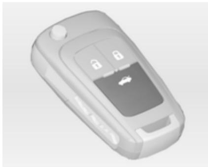
Чтобы отпереть крышку багажника, нажмите кнопку на пульте дистанционного управления, удерживая её не менее 2 секунд, а если нужно отпереть крышку изнутри, то нажмите клавишу на центральной консоли, после чего крышка багажника приоткроется.
