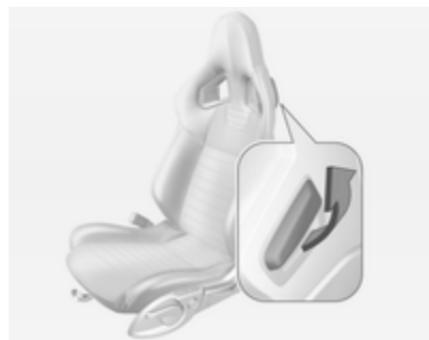
На иллюстрации показан рычаг фиксатора спинки сиденья модели OPC.
