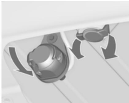
Отсоединить и опустить вниз розетку. Извлечь уплотнительную заглушку из отверстия для установки сцепной тяги с шаровой опорой и сохранить ее.
