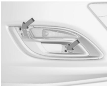
2. Отвернув оба винта, вынуть фонарь в сборе из бампера.
