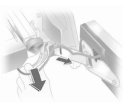
Нажать и опустить вниз зажимной рычаг, вытянуть опоры обеих ламп наружу из ячеек.
