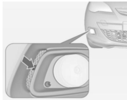
1. Отсоедините крышку, вставив отвертку в углубление, и снимите ее.
