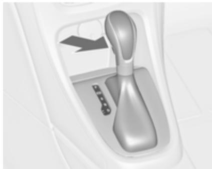
**P** = положение для парковки, колеса заблокированы, допускается устанавливать только на стоящем автомобиле с включенным стояночным тормозом
