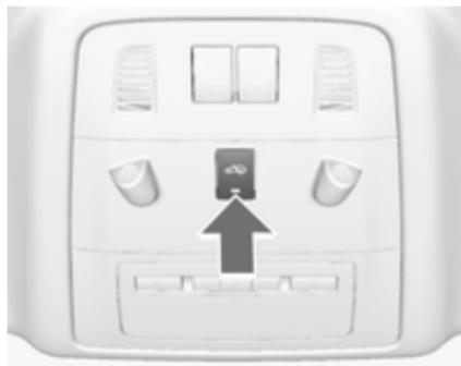
Следует выключить контроль пассажирского салона и наклона автомобиля, если внутри салона вы оставили животное, так как вредные для него ультразвуковые сигналы имеют высокую мощность, а движение животного может привести к срабатыванию противоугонной сигнализации. Систему также следует выключить при перевозке автомобиля на пароме или железнодорожным транспортом.
