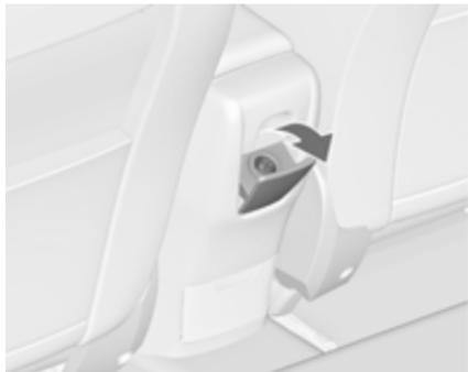
Еще одна розетка электропитания напряжением 12 вольт располагается в задней консоли. Опустить крышку вниз.
