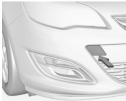
Вставьте отвертку в прорезь в нижней части колпачка. Освободить колпачок, аккуратно сдвинув отвертку вниз.
