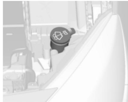
Залейте чистую воду, смешанную с соответствующим количеством содержащей антифриз промывочной жидкости.
