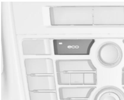
Чтобы принудительно отключить систему автоматической остановки и пуска двигателя, нажмите клавишу **eco**. При отключении системы светодиод в клавише гаснет.
