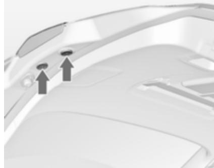
1. Открыв заднюю откидную дверь, снять сбоку заглушки.
