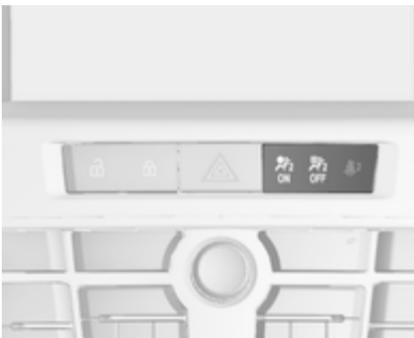
Если индикатор **↗<sub>2</sub>** горит после включения зажигания примерно 60 секунд, система надувных подушек безопасности переднего пассажира сработает в случае столкновения.
