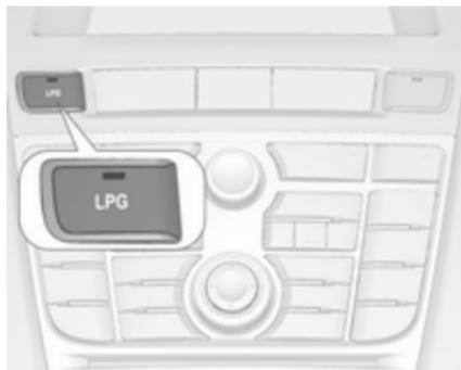
Клавишей LPG режимы питания переключаются с бензина на сжиженный газ и наоборот. Состояние светодиода — соответствует текущему рабочему режиму.
