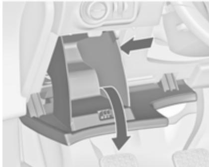
На автомобилях с левосторонним управлением коробка предохранителей располагается позади вещевого ящика на приборной панели.
