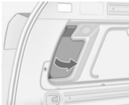
2. Снять крышку сбоку.
