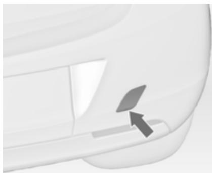
Вставьте отвертку в прорезь у нижней дуги колпачка. Освободить колпачок, аккуратно сдвинув отвертку вниз.
