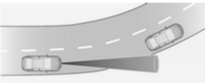
Система адаптивного круиз-контроля рассчитывает предполагаемую траекторию движения автомобиля, используя данные о центробежной силе. При расчете траектории учитывается кривизна участка, по которому автомобиль движется в текущий момент, однако система не способна учитывать возможные будущие изменения кривизны дороги. Движущееся перед вами транспортное средство может вы-
