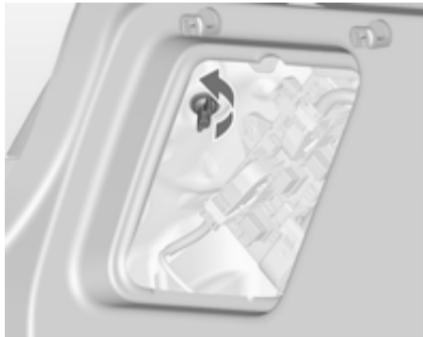
2. Вручную отвернуть пластмасовую крепежную гайку изнутри.
