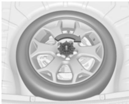
Поврежденное полноразмерное колесо кладётся в нишу для запасного колеса наружной стороной вверх и крепится гайкой-барашком. Коврик багажника можно уложить поверх выступающего из ниши колеса.
