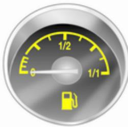
В зависимости от режима работы показывает уровень топлива или давление газа в баке.
