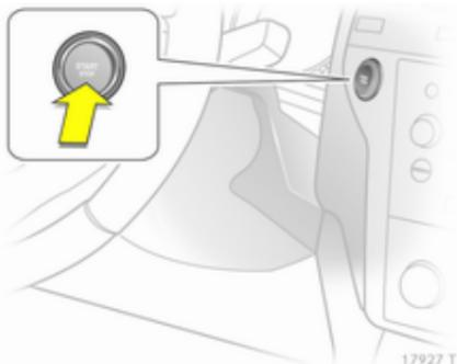
**Нажмите кнопку Start/Stop.** Включится зажигание. Иммобилайзер и замок рулевого колеса отключаются.
