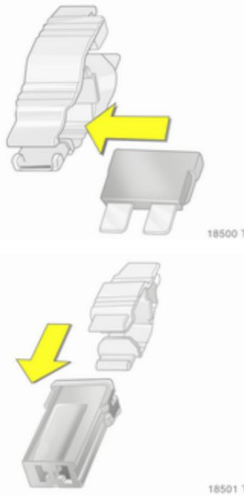
Наденьте приспособление на предохранитель сверху или сбоку, в зависимости от типа предохранителя, и выньте предохранитель.
