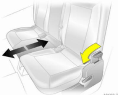
Нажмите рычаг фиксатора вперед и сдвиньте ряд сидений. Отпустите рычаг и зафиксируйте положения сидений с характерным щелчком.
