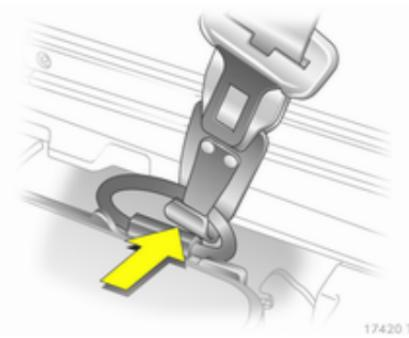
Для этого нажмите на пружинную серьгу и выньте крюк из проушины ремня в полу автомобиля.
