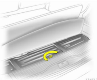
Для того чтобы открыть крышку, поднимите ковровый настил. Поднимите, поверните и вытяните кольцо.
