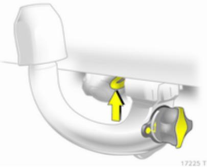
Заблокируйте тягово-сцепное устройство, повернув ключ в положение ② (2). Удалите ключ и закройте защитную крышку.
