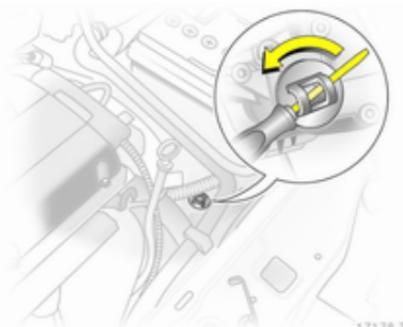
Для того, чтобы вывести автомобиль из транспортного потока, выключите сцепление:
