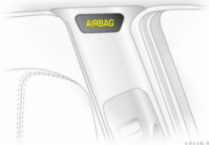
Система шторок безопасности включает подушки безопасности, установленные в раме крыши с каждой стороны. Эти подушки можно определить по надписи **AIRBAG** на стойках крыши.
