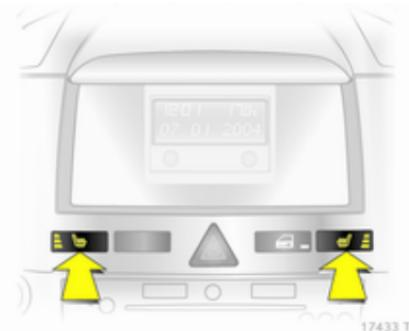
Для установки нужного подогрева сиденья нажмите один или несколько раз на кнопку при включенном зажигании. Выбранный уровень подогрева указывается на встроенным в кнопку индикаторе.
