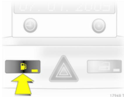
Нажатие на кнопку переключает режимы работы: с бензина на природный газ и наоборот. Режим работы не переключается при высоких нагрузках (например, во время интенсивного разгона или при полностью открытой дроссельной заслонке). Состояние светодиода соответствует текущему рабочему режиму.
