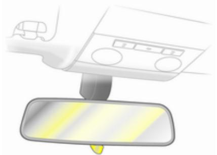
Для уменьшения бликов поверните рычаг на нижней части корпуса зеркала.
