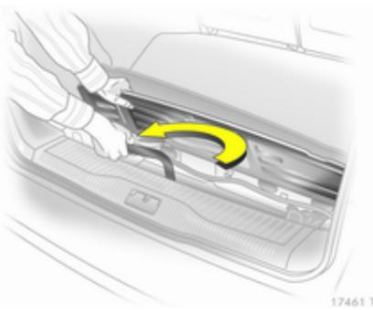
Запасное колесо хранится под полом автомобиля.
