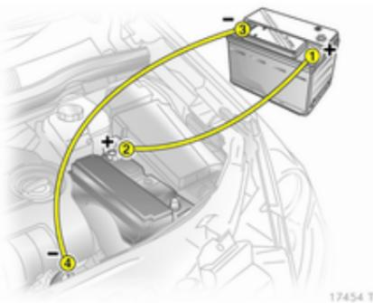
Порядок подключения проводов:
