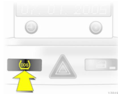
После подкачки шин или смены колеса систему нужно инициализировать: Включите зажигание, нажмите и удерживайте кнопку **DDS** примерно 4 секунды, индикатор (!) должен мигнуть три раза.
