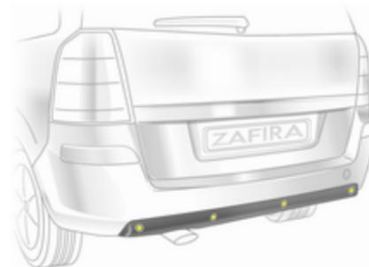
Система помощи при парковке облегчает парковку автомобиля, измеряя для этого расстояние между автомобилем и препятствиями. Однако это не в коей мере не снимает с водителя ответственность за постановку автомобиля на стоянку.
