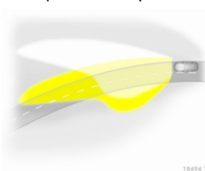
Поворот светового луча происходит в зависимости от положения рулевого колеса и скорости движения.
