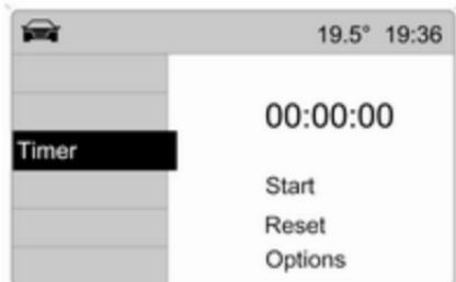
Из меню **Board Computer** (бортовой компьютер) выберите пункт **Timer** (таймер).
