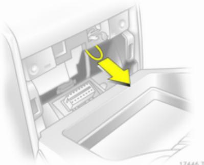
4. Потяните кольцо и сдвиньте селектор из положения **P** или **N**. Если снова перевести селектор в одно из этих положений, то он будет заблокирован повторно. Устранит причину потери напряжения питания на станции техобслуживания.
