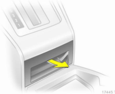
2. Снимите вкладыш пепельницы ⇒ 91. Отпустите винт металлической крышки и снимите обе детали. Автомобильный инструмент ⇒ 195.
