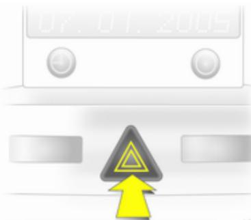
Включается с помощью кнопки . Аварийная световая сигнализация включается автоматически после срабатывания подушек безопасности.
