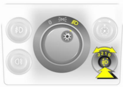
Чтобы изменить угол наклона фар с учетом загрузки автомобиля во избежание ослепления: Нажмите на ручку, для того чтобы ее разблокировать, и поверните в нужное положение.
