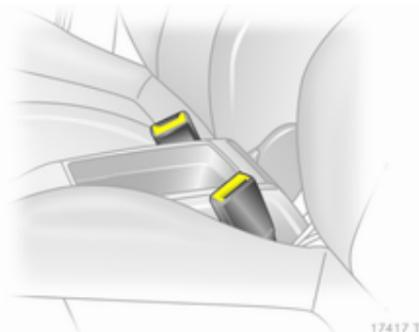
В случае значительного удара в автомобиль спереди или сзади происходит натяжение ремней безопасности передних сидений.
