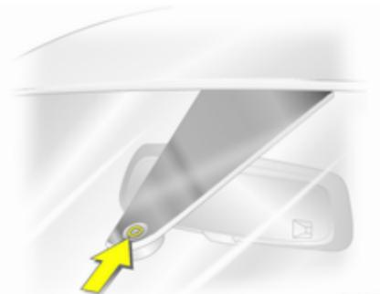
Не допускайте попадания на датчик пыли, грязи и льда.
