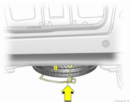
5. Снимите предохранительный трос.
