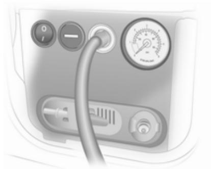
9. Включите компрессор, нажав кнопку выключателя. Шина заполнится герметиком.
