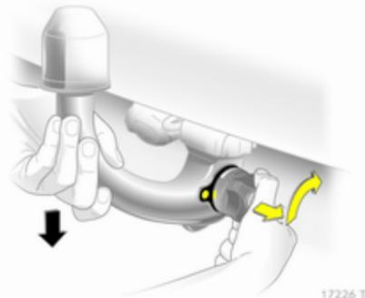
Для разблокирования устройства, откройте защитную крышку и поверните ключ в положение (1).
