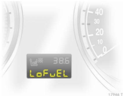
При работе на природном газе и низком уровне в топливном баке выводится сообщение **LoFuel**. Подтвердите сообщение, нажав кнопку сброса ⇨ 93.
