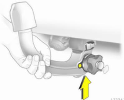
Натянутое устройство введите в отверстие и сильно надавите вверх до характерного щелчка.
