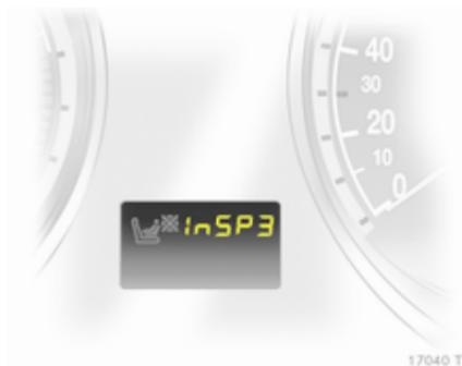
Замените батарейку, если система работает плохо, или уменьшилась ее дальность действия. На необходимость замены батарейки указывает InSP3 на дисплее технического обслуживания или контрольное сообщение на Info-Display ▷ 113.
