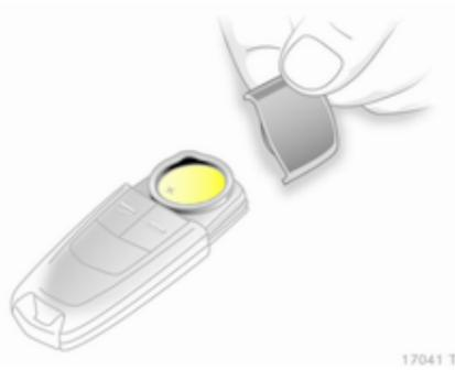
Для замены батарейки нажмите фиксатор и, слегка нажав, снимите колпачок. Надавите колпачок на противоположной стороне наружу. Заменить батарейку (тип CR 2032), обращая внимание на ее правильное положение при установке. Заденьте крышки.
