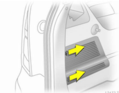
Блок предохранителей расположен за облицовкой. Нажмите лепестки фиксатора вперед и снимите облицовку.
