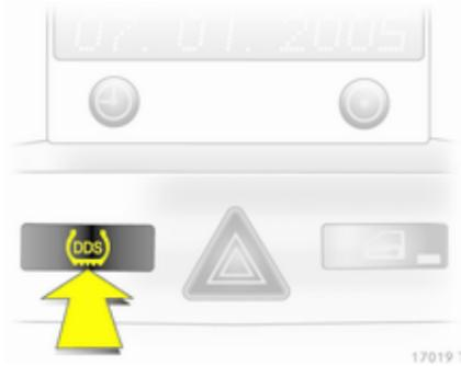
После замены колеса систему следует инициализировать: накачайте шины до указанного давления, включите зажигание, нажмите и удерживайте кнопку DDS примерно 4 секунды, индикатор  $\text{!}$  должен мигнуть три раза.
