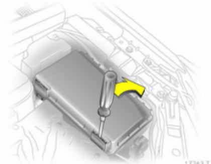
Вставьте отвертку в отверстие как можно глубже и наклоните ее в сторону. Поднимите крышку вверх и снимите ее.
