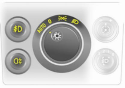
Поверните выключатель осветительных приборов
