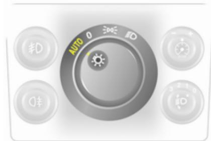
Переключатель освещения установлен в положение **AUTO**: При работающем двигателе и недостаточном внешнем освещении включаются наружные световые приборы.
