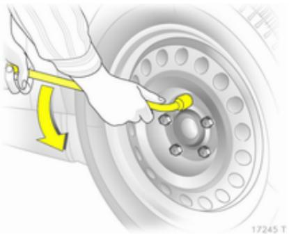
2. Установить колесный ключ так, чтобы он был надежно надет на болт, слегка отвернуть каждый болт на пол-оборота.
