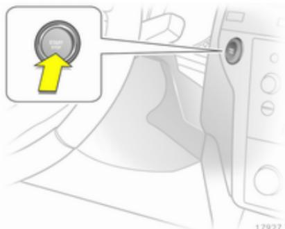
Электронный ключ должен находиться внутри автомобиля. Нажать педаль сцепления и тормоза, установить рычаг переключения автоматической коробки передач в положение **P** или **N**.
