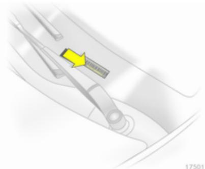
Идентификационный номер автомобиля может быть оттиснен на приборной панели и виден через ветровое стекло.
