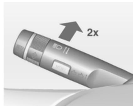
Чтобы включить систему автоматического переключения дальнего света, необходимо после достижения скорости 40 км/ч дважды нажать на рычаг указателей поворота.
