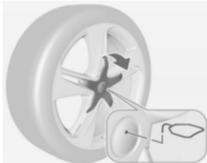
Литые диски с центральной крышкой болтов: Отсоедините центральную крышку, вставив съемник  $\diamond$  205 в углубление эмблемы и вытянув его.
