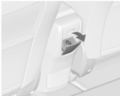
Еще одна розетка электропитания напряжением 12 вольт располагается в задней консоли. Опустить крышку вниз.
