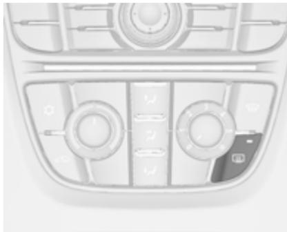
Включается при нажатии кнопки . Обогрев включается только при работающем двигателе и через короткое время отключается.
