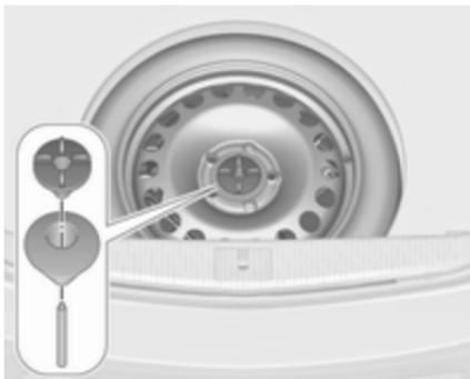
3. Установите эксцентрический конус в углубление запасного колеса и закрепите его, навернув гайку-барашек.
