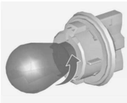
3. Извлеките лампу из патрона, вращая ее против часовой стрелки.
