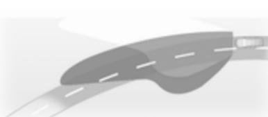
В зависимости от положения рулевого колеса и скорости движения происходит поворот светового луча, чем достигается улучшенная освещенность полотна дороги во время прохождения поворота.
