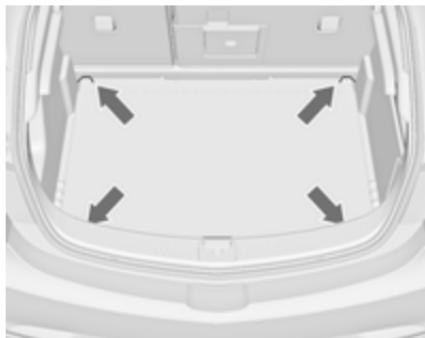
Крепежные проушины предназначены для предотвращения смещения предметов, например, с помощью крепежных ремней или багажной сетки.
