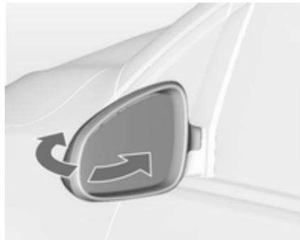
Для обеспечения безопасности пешеходов внешние зеркала складываются от удара определенной силы. Для того чтобы вернуть
