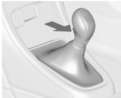
Чтобы включить задний ход, при неподвижном автомобиле выжать педаль сцепления, через 3 секунды нажать кнопку освобождения на рычаге переключения и включить передачу.
