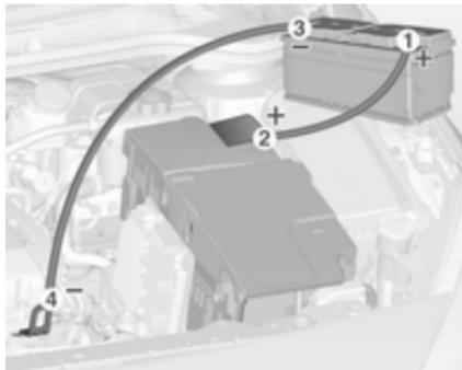
Порядок подключения проводов:
