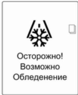
Если наружная температура опускается до 3 °C, на автомобилях с дисплеем верхнего уровня или комбинированным дисплеем верхнего уровня информационного центра водителя выводится предупредительное сообщение.
