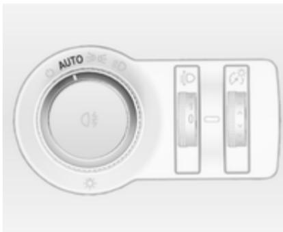
При включенном автоматическом управлении освещением и работающем двигателе осуществляется автоматический переход между режимами дневного света
