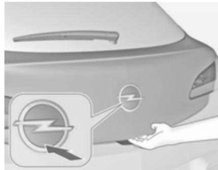
Чтобы открыть заднюю откидную дверь, нажмите на панель с эмблемой на нижней половине.
