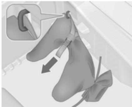
Мешок со сцепной тягой с шаровой опорой хранят в заднем вещевом отсеке хранения на полу.
