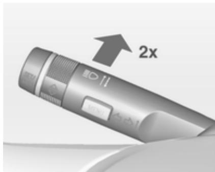
Интеллектуальная система регулировки дальности света фар и функция автоматического включения и отключения дальнего света включаются одновременно двукратным нажатием рычага подрулевого переключателя указателей поворота. Эти функции включаются при включенном зажигании.
