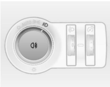
Включается с помощью кнопки D. Переключатель освещения находится в положении AUTO: при включении заднего противотуманного фонаря основные фары включаются автоматически.
