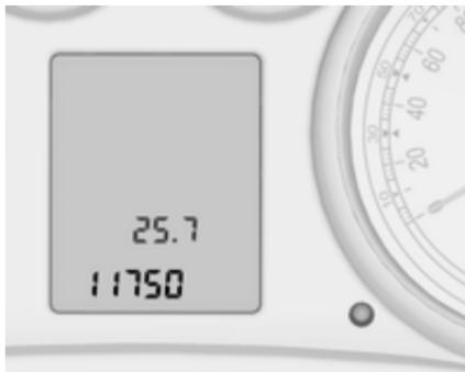
Информационный центр водителя расположен в комбинации приборов между спидометром и тахометром. Он может быть выполнен в виде дисплея среднего уровня, дисплея верхнего уровня или комбинированного дисплея верхнего уровня.
