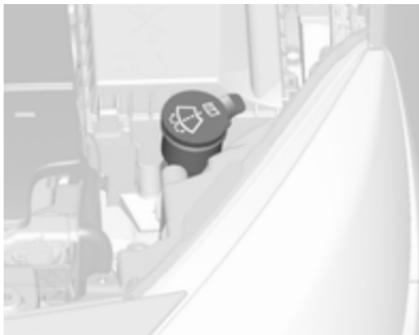
Залейте чистую воду, смешанную с соответствующим количеством содержащей антифриз промывочной жидкости. Надлежащая пропорция смешивания жидкости для омывателя указана на контейнере с этой жидкостью.
