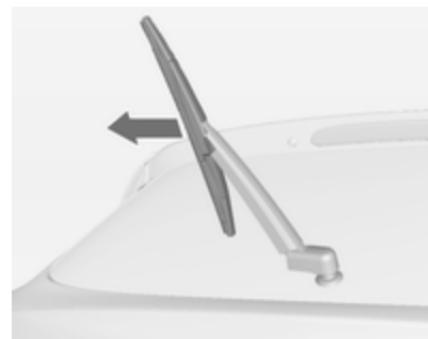
Поднять рычаг стеклоочистителя. Отсоедините щетку стеклоочистителя, как показано на рисунке, и снимите ее.
