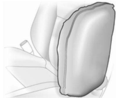
Надутые воздушные подушки безопасности амортизируют удар, тем самым они снижают опасность травмирования верхней части туловища и таза в случае серьезного бокового удара.
