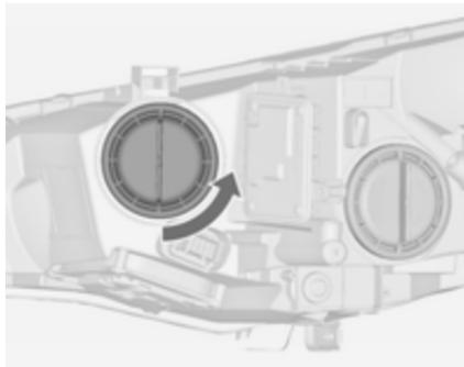
1. Повернуть колпачок против часовой стрелки и извлечь его.
