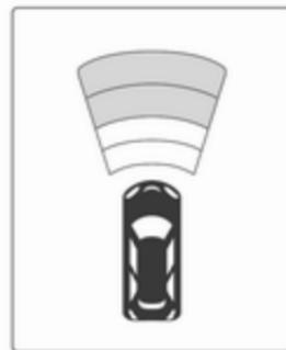
В зависимости от модели, дистанция до препятствия спереди может указываться на дисплее информационного центра водителя в виде подсвечиваемых сегментов.
