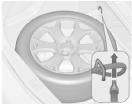
2. Продеть петлю на конце крепежного ремня в проушины спереди с соответствующей стороны.
