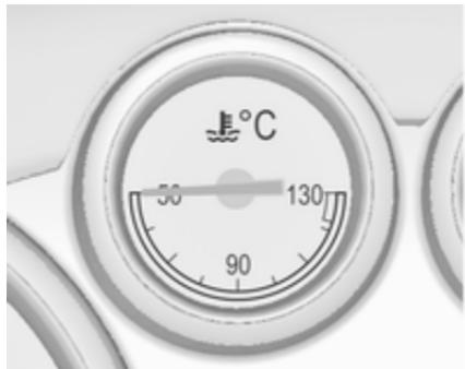
Отображает температуру охлаждающей жидкости двигателя.
