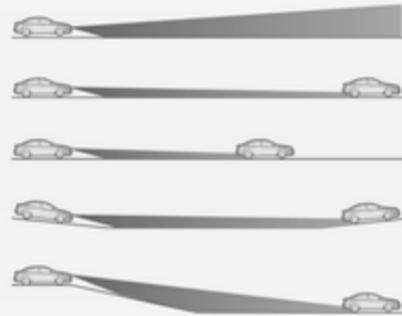
Специальная функция топографической оценки позволяет обнаруживать впередиидущие транспортные средства на спусках и подъемах, отслеживая огни задних фонарей. Система регулирует угол наклона светового пучка, обеспечивая оптимальное освещение дороги и при этом не ослепляя других водителей.
