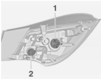
5. Выкрутите и замените лампу, вращая патрон против часовой стрелки.
