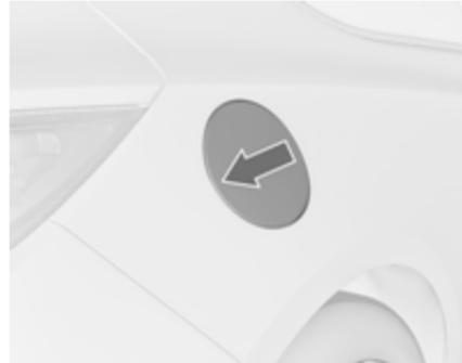
Заправочный лючок открывается только если замки автомобиля разблокированы. Откройте крышку топливозаправочной горловины, нажав на нее.
