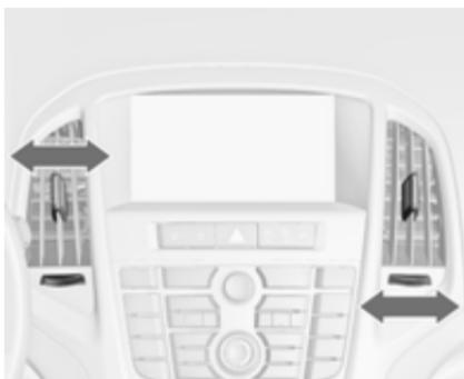
Чтобы открыть вентиляционное отверстие, следует повернуть колесико регулятора в сторону символа ■ открытия. Регулировка количе-
