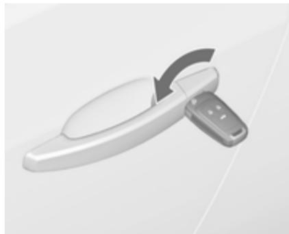
Разблокируйте дверь водителя вручную, повернув ключ в замке. Чтобы отпереть дверь пассажира, багажник и откидную крышку заправочной горловины топливного бака, включите зажигание и нажмите кнопку центрального замка
