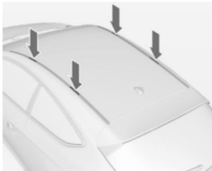
Отсоединить крышку каждой монтажной точки с помощью монеты.
