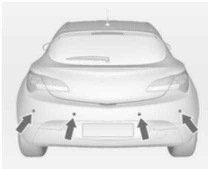
Система помощи при парковке облегчает парковку автомобиля путем измерения расстояния от автомобиля до расположенных сзади препятствий и подачи звуковых сигналов.
