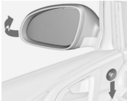
Поверните выключатель в положение **0** и нажмите на рычаг выключателя сверху вниз. При этом оба наружных зеркала складываются. При повторном нажатии на выключатель оба зеркала вернутся в исходное положение.
