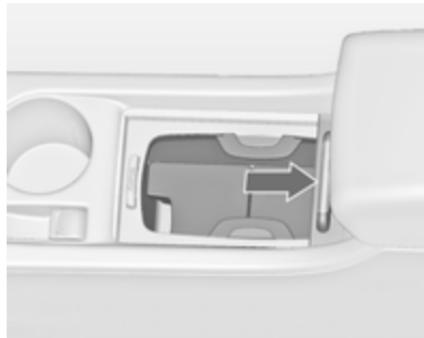
В зависимости от модификации подстаканники могут располагаться под крышкой в центральной консоли. Сдвинуть крышку назад. Бутылки можно хранить после складывания вверх промежуточной полки  $\Phi$  62.
