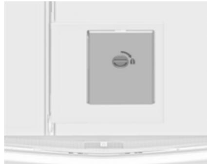
Закрытую крышку можно закрепить сбоку багажного отделения. Повернуть ручку на 90°:
