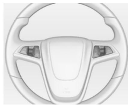
С помощью клавиш на рулевом колесе можно управлять информационно-развлекательной системой, круиз-контролем, ограничителем скорости и подключенным сотовым телефоном.
