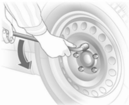
2. Установить колесный ключ так, чтобы он был надежно надет на гайку, слегка отвернуть каждую колесную гайку на пол-оборота.
