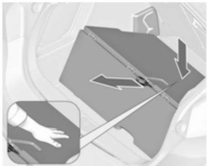
Чтобы опустить крышку, следует потянуть ремень назад и одновременно опустить середину передней части крышки.
