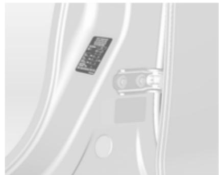
Давление в шинах ▷ 243 указано на табличке, расположенной на раме левой передней двери.
