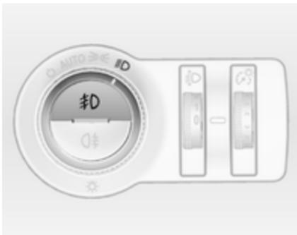
Включается с помощью кнопки FD. Переключатель освещения находится в положении AUTO: при включении передних противотуманных фар основные фары включаются автоматически.
