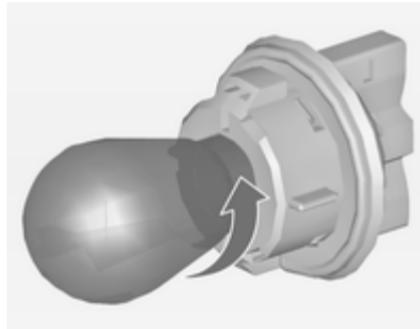
3. Извлеките лампу из патрона, вращая ее против часовой стрелки.
