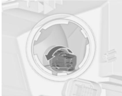
2. Поверните патрон лампы против часовой стрелки и выньте его.
