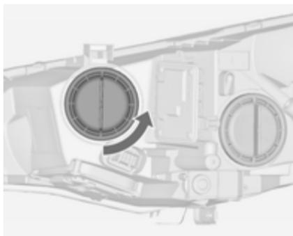
1. Повернуть колпачок против часовой стрелки и извлечь его.
