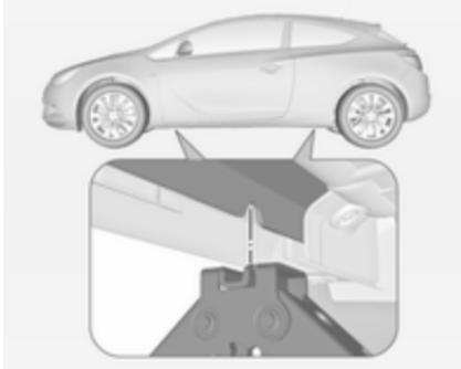
3. Убедиться, что домкрат надлежащим образом установлен под соответствующей подъемной точкой на автомобиле. На автомобилях со стальными панелями порога необходимо сначала снять заглушку со штатного места под установку домкрата.
