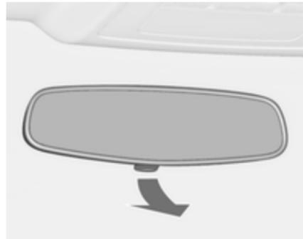
Для уменьшения бликов отрегулируйте положение рычага на нижней части корпуса зеркала.
