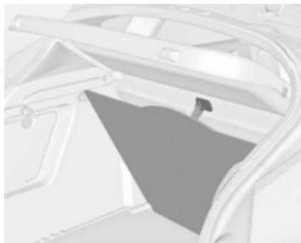
Заднюю крышку пола можно поднять. Зацепите петлю за крючок на нижней стороне крышки багажника.
