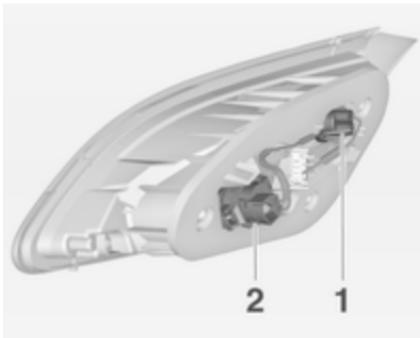
4. Поверните патрон лампы против часовой стрелки и выньте его из отражателя.
