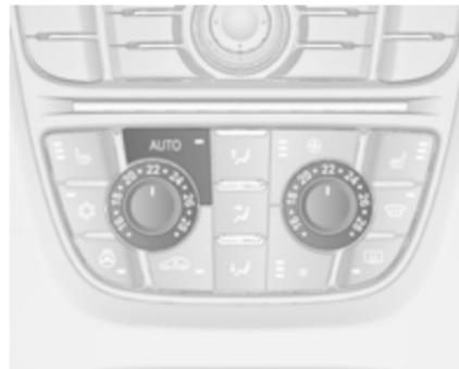
Если установлена минимальная температура, система климат-контроля работает при максимальном охлаждении.
