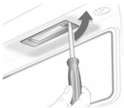
1. Вставить отвертку в паз крышки, нажать вбок и освободить пружину. Снять крышку.
