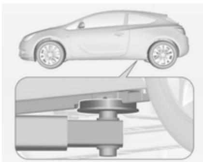
Задний рычаг подъемной платформы располагают по центру под пазом порога кузова.
