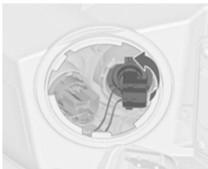
2. Повернуть патрон лампы против часовой стрелки и освободить. Выньте патрон лампы из отражателя.
