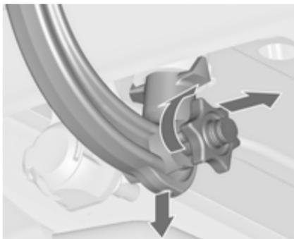
Снять защитную крышку и поворотом ключа в положение
