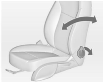
Потяните рычаг, отрегулируйте наклон и отпустите рычаг. Сиденье должно зафиксироваться в новом положении с характерным щелчком.
