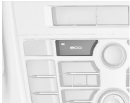
Чтобы принудительно отключить систему автоматической остановки и пуска двигателя, нажмите клавишу **eco**. При отключении системы светодиод подсветки клавиши гаснет.
