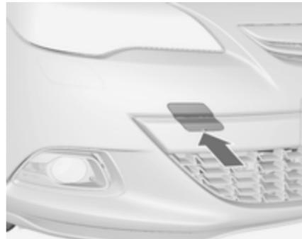
Вставьте отвертку в прорезь у нижней дуги колпачка. Освободить колпачок, аккуратно сдвинув отвертку вниз.
