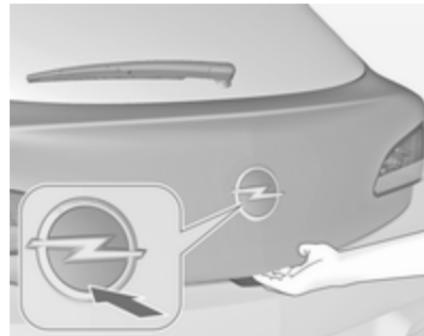
Для отпирания и открывания задней откидной двери нажмите кнопку на радиобрелоке дистанционного управления или нажмите на панель с эмблемой на нижней половине.
