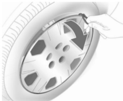
1. Подцепите колпачки колесных гаек отверткой и снимите их. Снимите колесный колпак с помощью крюка. Автомобильный инструмент  $\diamond$  205.
