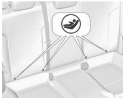
Прикрепить разрешенную для применения в автомобиле систему крепления ISOFIX детских кресел безопасности к монтажным кронштейнам ISOFIX. Позиции крепления ISOFIX детских кресел безопасности, применяемые для конкретного автомобиля, отмечены в таблице сокращением IL.
