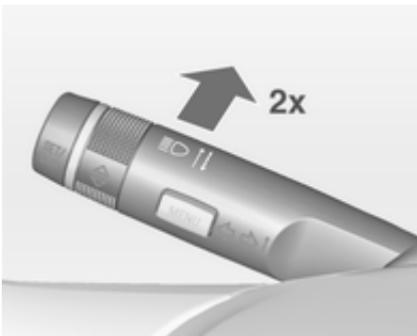
Чтобы включить систему автоматического переключения дальнего света, необходимо после достижения скорости 40 км/ч дважды нажать на рычаг указателей поворота.
