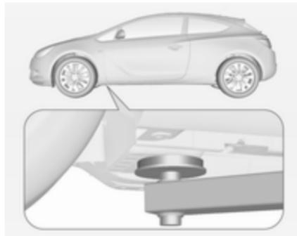
Передний рычаг подъемной платформы располагают под днищем автомобиля.
