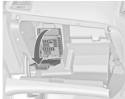
На автомобилях с правосторонним рулевым управлением блок предохранителей расположен за крышкой в перчаточном ящике. Открыть передний вещевой ящик, затем открыть крышку и опустить ее вниз.
