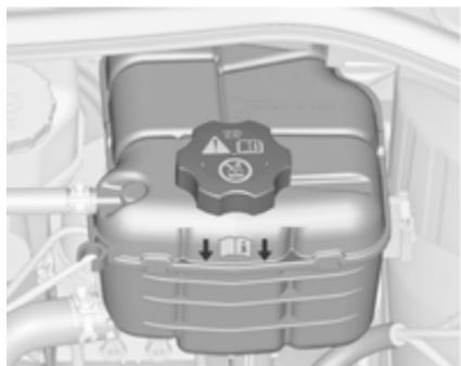
Если система охлаждения холодная, уровень охлаждающей жидкости должен быть выше заправочной метки. Если уровень низкий, долейте охлаждающую жидкость.
