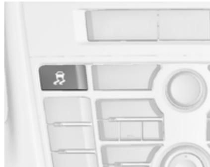
Систему контроля тягового усилия ТС можно выключить, если требуется пробуксовка ведущих колес автомобиля, для этого кратковременно нажмите кнопку
