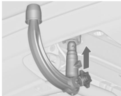
Вставить в отверстие затянутую сцепную тягу с шаровой опорой и плотно прижать ее вверх до ощущимого щелчка.
