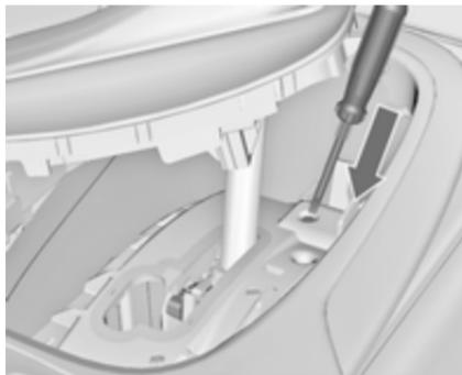
3. Вставьте отвертку в отверстие как можно глубже и выведите рычаг селектора из положения **P** или **N**. Если снова перевести селектор в положение **P** или **N**, то он будет заблокирован повторно. Устранимте причину потери напряжения питания на станции техобслуживания.
