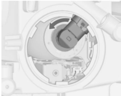
2. Повернуть патрон лампы против часовой стрелки и освободить. Выньте патрон лампы из отражателя.
