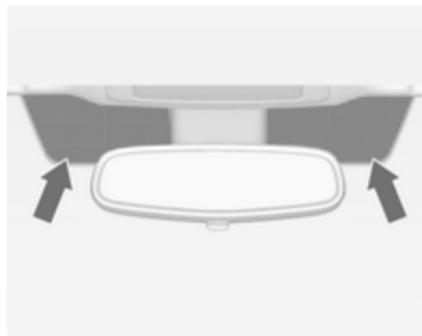
Отмеченные участки стекла рядом с внутренним зеркалом заднего вида не имеют этого покрытия. Уст-
