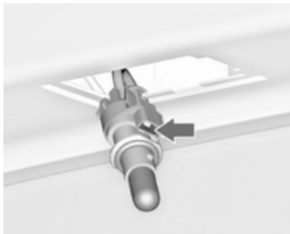
3. Освободить стопорный выступ и извлечь патрон лампы из разъема жгута проводов.
