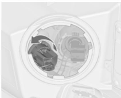
2. Поверните патрон против часовой стрелки, чтобы отсоединить его. Извлеките патрон лампы из отражателя.
