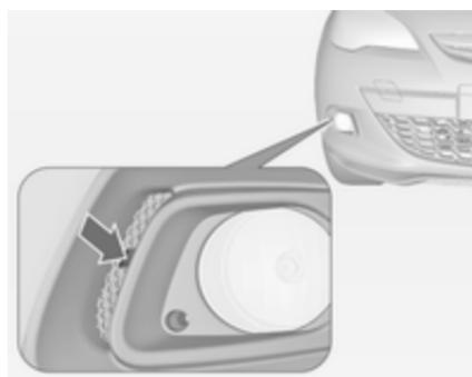
1. Отсоедините крышку, вставив отвертку в углубление, и снимите ее.
