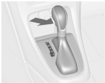
**R** = положение для парковки, колеса заблокированы, допускается устанавливать только на стоящем автомобиле с включенным стояночным тормозом
