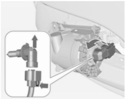
3. Повернуть патрон лампы против часовой стрелки и извлечь его из рефлектора.
