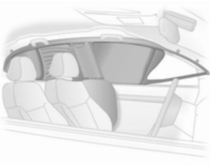
Надутые воздушные подушки безопасности амортизируют удар, тем самым они снижают опасность травмирования головы в случае серьезного бокового удара.
