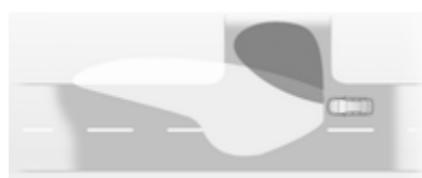
На крутых поворотах или при разворотах в зависимости от угла поворота руля или включенного указателя поворотов включается дополнительный левый или правый рефlector, который освещает дорогу под прямым углом к направлению движения автомобиля. Данный режим включается на скорости до 40 км/ч.
