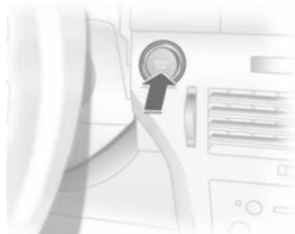
Электронный ключ должен находиться внутри автомобиля. Выжмите педали сцепления и тормоза, установите автоматическую коробку передач в положение **P** или **N**, педаль акселератора
