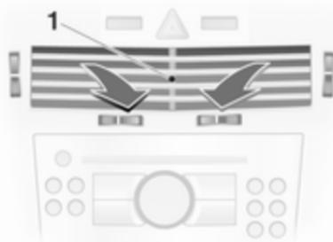
Чтобы открыть отверстие, поверните регулировочный маховик в положение I.
