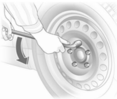
2. Установить колесный ключ так, чтобы он был надежно надет на болт, слегка отвернуть каждый болт на пол-оборота.
