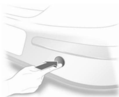
Отцепите крышку снизу и снимите вниз.
