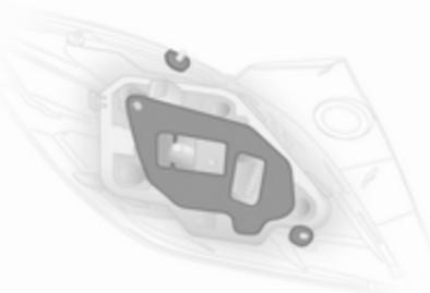
8. Проверьте, вложены ли уплотнения в патрон лампы и зафиксированы ли винты.
