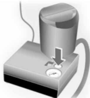
13. Рабочее давление в шине установится примерно через 10 минут. Давление в шинах  $\Phi$  256 При достижении соответствующего давления выключите компрессор.
