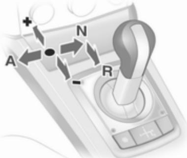
Всегда передвигайте селектор передач в нужном направлении до упора. Отпущененный, он автоматически возвращается в центральное положение.
