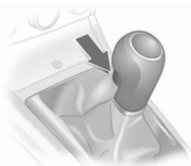
Чтобы включить задний ход, при неподвижном автомобиле выжать педаль сцепления, через 3 секунды нажать вверх кнопку освобождения на рычаге переключения и включить передачу.
