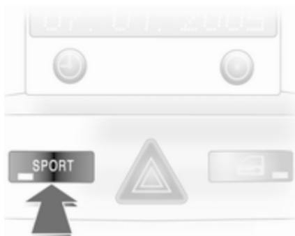
Система ESP®<sup>Plus</sup> может быть отключена при включении для повышения эффективности вождения в режиме Sport:
