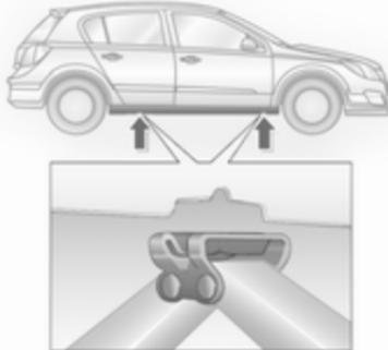
3. Проследите, чтобы домкрат был установлен в точках поддомкрачивания автомобиля.
