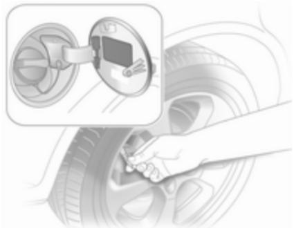
Снимите ключ для откручивания колпачков вентиляй колес с лючка бензобака и с его помощью отверните колпачок.
