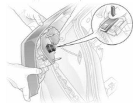
2. Демонтируйте корпус лампы снаружи. Освободите заглушку, нажимая на крышку, и снимите ее с патрона лампы.
