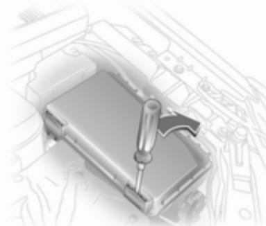
Вставьте отвертку в отверстие как можно глубже и наклоните ее в сторону. Поднимите крышку вверх и снимите ее.
