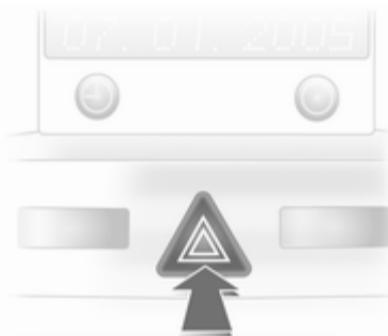
Включается с помощью кнопки
