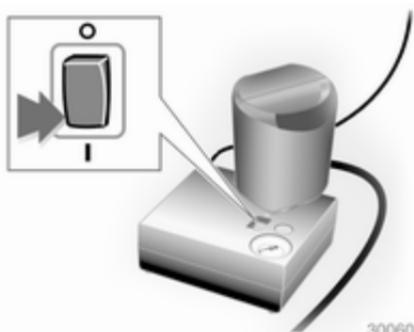
10. Установите кулисный переключатель компрессора в положение **I**. Шина наполнится герметиком.
