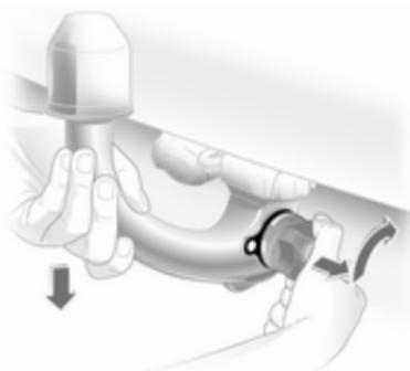
Для разблокирования устройства, откройте защитную крышку и поверните ключ в положение
