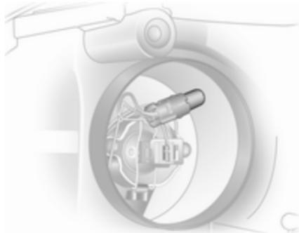
4. Выньте лампу из гнезда и установите новую лампу.
