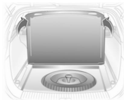
Удалите переходник и крюки из направляющих в стенках багажного отделения. Поднимите задние крепежные проушины и установите крышку пола в вертикальное положение таким образом, чтобы она
