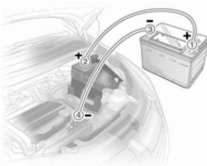
Порядок подключения проводов:
