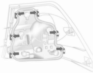
5. Выдавите шесть блокировочных фиксаторов корпуса лампы и снимите держатель лампы.
