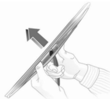
Поднимите рычаг стеклоочистителя. Разблокируйте и снимите щетки стеклоочистителя.
