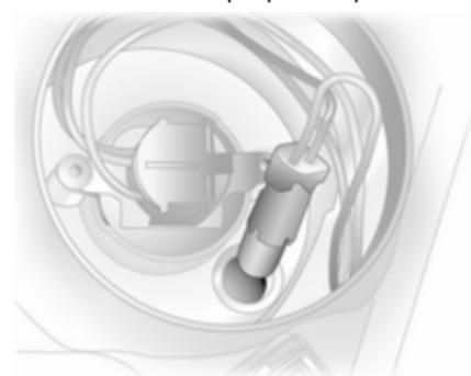
4. Выньте лампу из гнезда и установите новую лампу.
