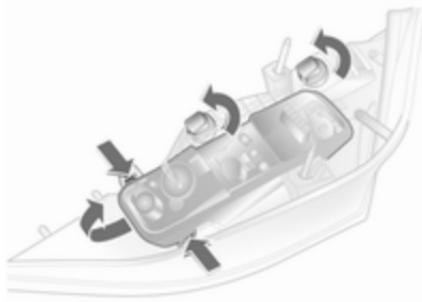
4. Освободите розетки, поворачивая и удаляя их. Нажмите на фиксирующие выступы по длинной стороне патрона лампы снаружи; поднимите патрон лампы за передний конец и демонтируйте его.
