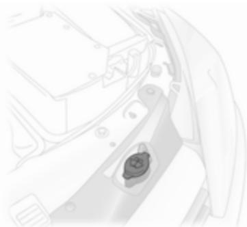
Залейте чистую воду, смешанную с соответствующим количеством содержащей антифриз промывочной жидкости.
