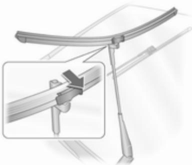
Поднимите рычаг стеклоочистителя, наклоните щетку на 90° к рычагу и снимите ее движением вбок.
