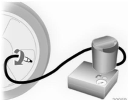
6. Отверните колпачок вентиля поврежденной шины.
