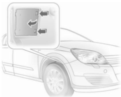
Замена ламп крайних передних приборов осуществляется через проемы в передней колесной нише: поверните колеса, чтобы
