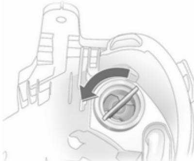
2. Поверните патрон лампы против часовой стрелки и выньте его.
