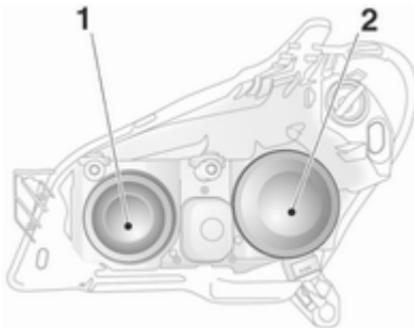
Данный тип фар имеет раздельные системы дальнего света 1 (внутренние лампы) и ближнего света 2 (наружные лампы).
