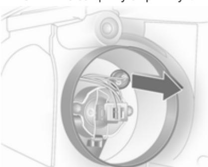
3. Выньте патрон лампы стояночного огня из отражателя.
