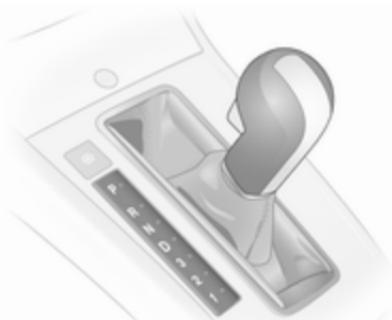
**P** = положение "Парковка". Передние колеса заблокированы. Включайте только при неподвижном автомобиле при затянутом стояночном тормозе
