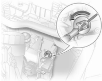
Если автомобиль необходимо вывести из дорожного потока, отсоедините сцепление следующим образом (касается только 5-скоростной автоматизированной механической коробки передач):
