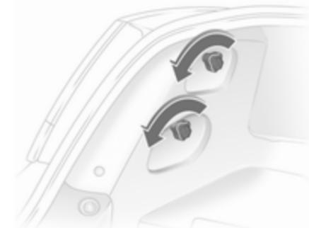
1. Выкрутите стопорные гайки.
