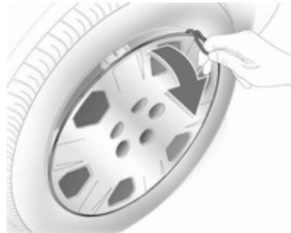
1. Снимите колесный колпак с помощью крюка. Автомобильный инструмент  $\diamond$  209.
