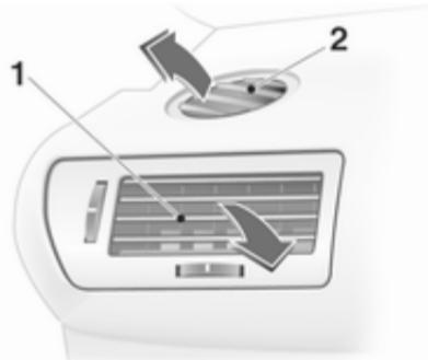
Наклоняя и поворачивая решетку, установите требуемое направление потока воздуха.
