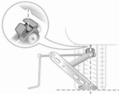
4. Установите предварительно развернутый до нужной высоты домкрат непосредственно в точке поддомкрачивания таким образом, чтобы предотвратить его смещение.
