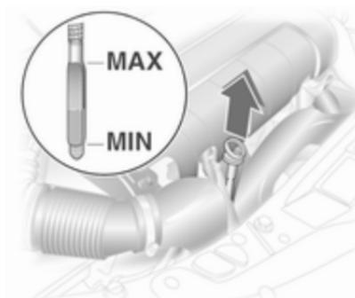
Если уровень моторного масла упал до отметки **MIN**, необходимо долить моторное масло.
