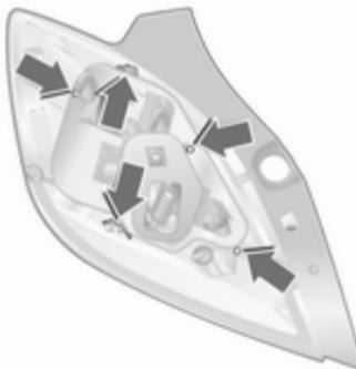
5. Выверните с помощью отвертки три винта. Нажмите на фиксирующие выступы на внутренней стороне держателя лампы и снимите держатель лампы.
