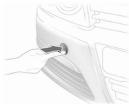
Разблокируйте крышку в нижней части и снимите ее вниз.
