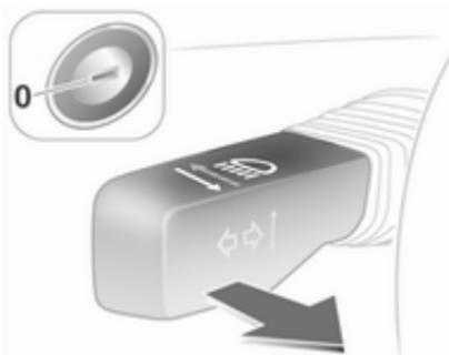
После включения системы и закрытия двери водителя передние фары и фонари заднего хода включаются примерно на 30 секунд.
