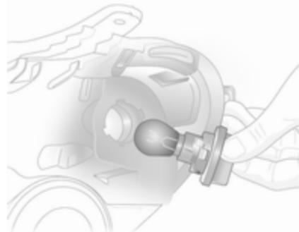
3. Слегка втолкните патрон лампы в гнездо, поверните против часовой стрелки, демонтируйте и замените лампу.
