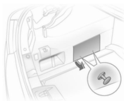
Чтобы открыть, вытяните две кнопки, снимите зажимы и поднимите крышку.
