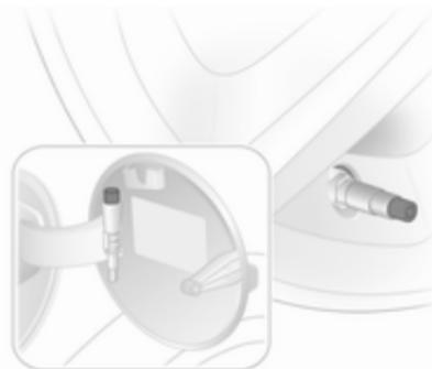
На автомобилях с системой контроля давления в шинах наверните на вентиль переходник.
