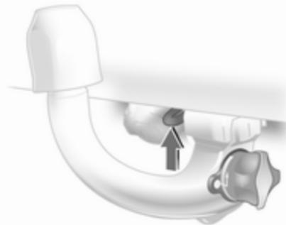
Заблокируйте тягово-сцепное устройство, повернув ключ в положение
