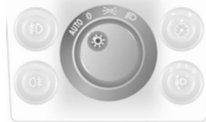
Переключатель освещения установлен в положение **AUTO**: При работающем двигателе и недостаточном внешнем освещении включаются наружные световые приборы.
