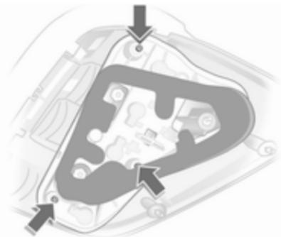
4. Выкрутите с помощью отвертки три винта и снимите патрон лампы. Автомобильный инструмент  $\diamond$  209.
