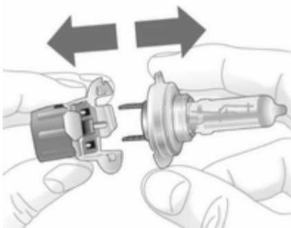
5. Вставьте патрон, проденьте два лепестка в отражатель и закрепите его на месте, повернув по часовой стрелке.
