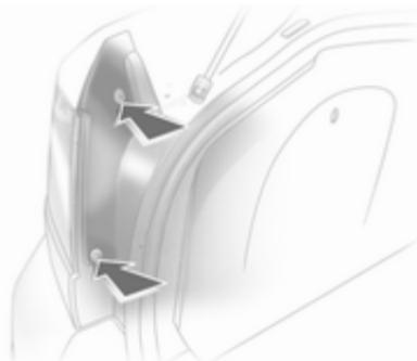
3. Выкрутите с помощью отвертки три винта и снимите патрон лампы. Автомобильный инструмент ⇨ 209.
