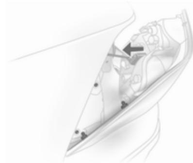
4. Выдавите назад задние огни, придерживая корпус лампы снаружи. Отсоедините провод от держателя лампы.
