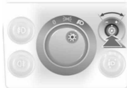
Яркость подсветки можно отрегулировать при включенном наружном освещении: Разблокируйте кнопку
