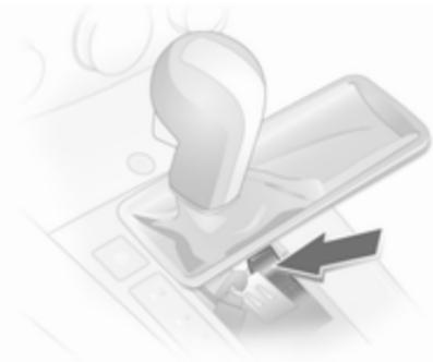
3. С помощью отвертки сожмите желтую пружину фиксатора вперед и передвиньте рычаг селектора из положения **P**.
