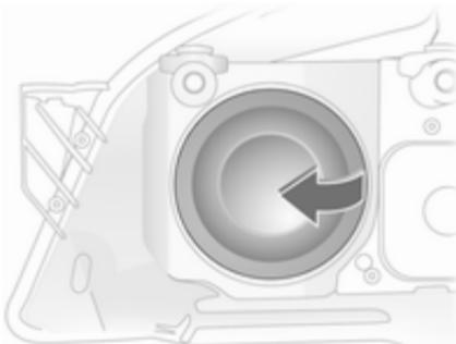
2. Снимите защитную крышку 1.
