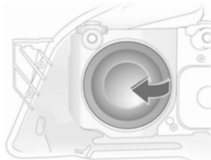
2. Снимите защитную крышку 1.
