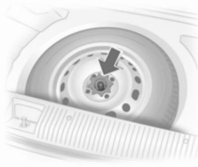
Запасное колесо находится в багажном отделении под крышкой пола. Оно крепится в нише с помощью барашковой гайки.
