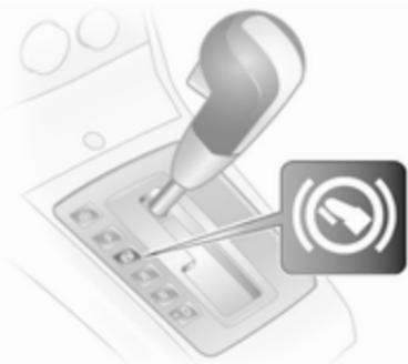
Если селектор установлен в положение **P** или **N**, при заблокированном селекторе индикатор передач светится красным светом. Если при выключенном зажигании селектор передач установлен в любое положение, кроме **P**, мигают индикаторы **(D)** и **(R)** из группы индикаторов передач.
