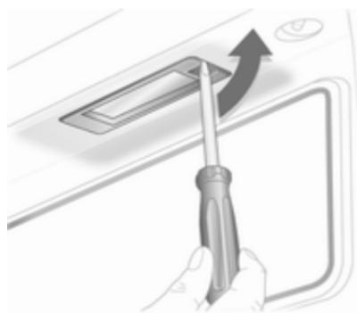
1. Вставьте отвертку в корпус, нажмите в сторону и освободите пружину.
