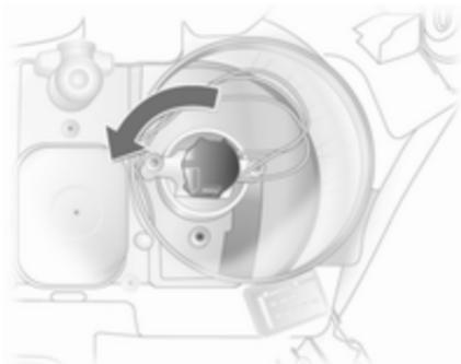
3. Повернуть патрон лампы против часовой стрелки и освободить. Выньте патрон лампы из отражателя.
