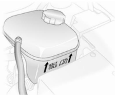
Когда система охлаждения холодная, уровень охлаждающей жидкости должен быть выше метки **KALT/COLD**. Если уровень низкий, долейте охлаждающую жидкость.
