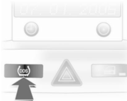
После замены колеса систему следует инициализировать: накачайте шины до указанного давления, включите зажигание, нажмите и удерживайте кнопку DDS примерно 4 секунды, индикатор  $\text{!}$  должен мигнуть три раза.
