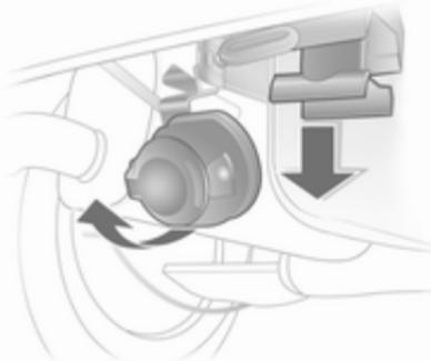
Откройте гнездо. Снимите заглушку с отверстия для шаровой опоры и поместите ее в багажное отделение.
