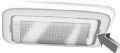
1. Выдавите фонарь с помощью отвертки.
